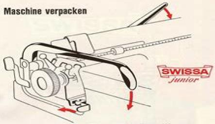
Durch Druck auf den verchromten Griff den Wagenarretierhebel nach hinten schnappen lassen. Den Wagen in die Mitte der Maschine bewegen, wodurch der Hebel automatisch den Wagen arretiert.
