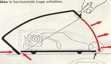
Den Kofferdeckel von hinten über die Maschine ziehen. Dabei beachten, daß das Bodenbrett richtig im Deckel eingreift. Mit der rechten Hand im Koffergriff, Deckel umklappen und gleichzeitig nach vom ziehen, damit die Verschlußriegel die Karosserie nicht beschödigen.
