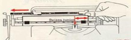
Für den Endzeilenrand in gleicher Weise verfahren. Den Wagen nach links bis zum gewünschten Punkt verschieben, unter Verwendung des Typenführungskopfes als Anhaltspunkt. Dann den Randsteller mit dem Daumen der rechten Hand bis zum Anschlag
