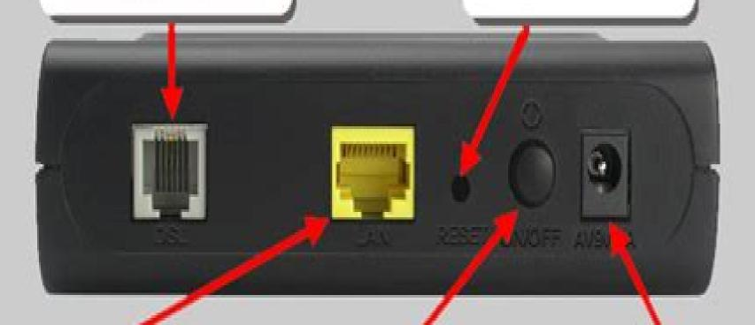
Порт Ethernet для подключения Ethernet кабеля
