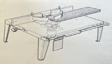
POF 52 stationar an BOSCH Sagestach S.S.L. S.10 L. oder MT 92 montiert. Zusatz, Montageplatte, Anschlaglineal mit Schutzvorrichtung.
