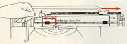
Das Einstellen der Ränder erfolgt durch seitliches Verschieben des Wagens mit dem Blatt bis zum gewünschten Zeilenanfangspunkt unter Benützung des Typenführungskopfes als Anhaltspunkt (oberes Bild). Dann den Randsteller mit dem Daumen der linken Hand bis zum Anschlag schieben.
